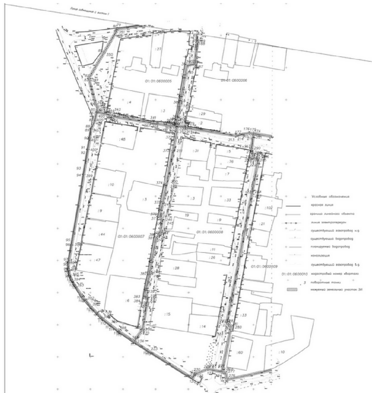
Схема межевания планируемого объекта М 1:1000
